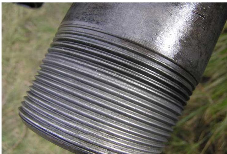
Рис. 3. Резьбовое соединение НКТ после диффузионного оцинкования
